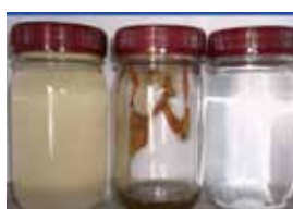
原水 釜残渣 回収水 減容率:94.25%
