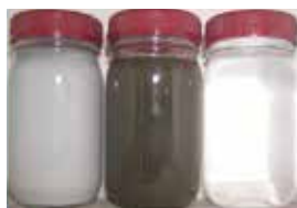
原水 釜残渣 回収水 減容率:93.20%
