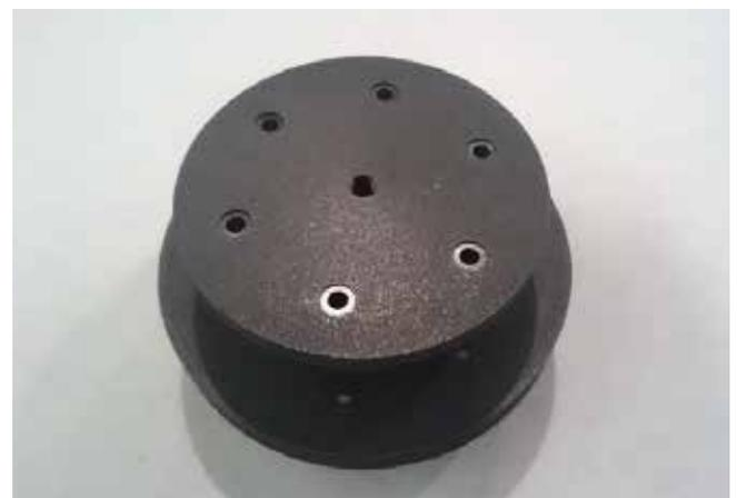
■ 電子顕微鏡用試料台
