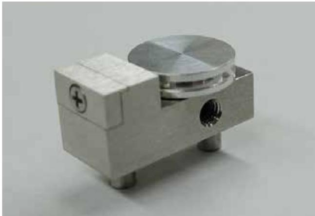
■ 電子顕微鏡用試料台
