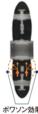
キャスター接地面の硬度は、通常キャスターと同一で、中心軸との間を一体構造とし、内輪(振動吸収層)の硬度は、軟質ゴムを用いたやわらかい構造を実現。軟質ゴムがポワソン効果の働きによって振動を分散させ、免振性を確立しています。
